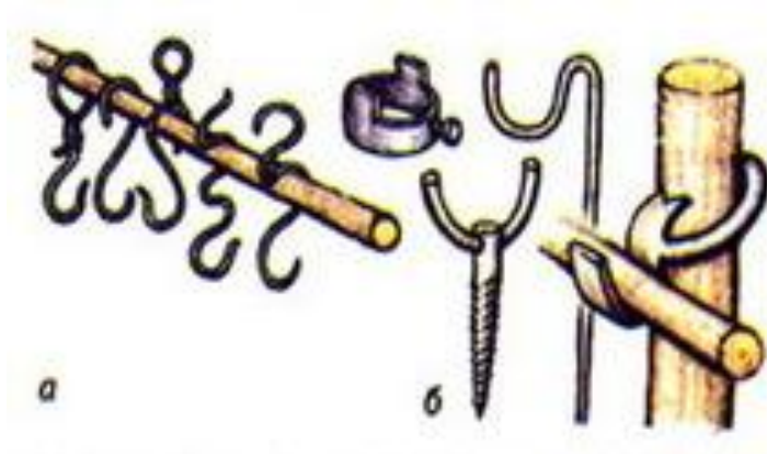
Рис. 8. Крючки и цепочки для подвески посуды (а) и металлические держатели костровых перекладин.
